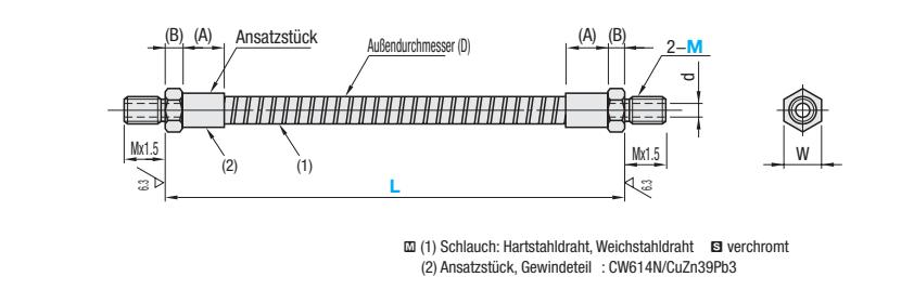
(1) Schlauch: Hartstahldraht, Weichstahldraht S verchromt
