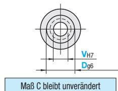
☺ Das Nitrieren kann sich auf den Kopf erstrecken, wenn es nach der Bearbeitung des Maßes V und D durchgeführt wird.
