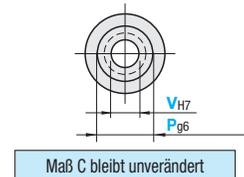
Das Nitrieren kann sich auf den Kopf erstrecken, wenn es nach der Bearbeitung des Maßes V und P durchgeführt wird.
