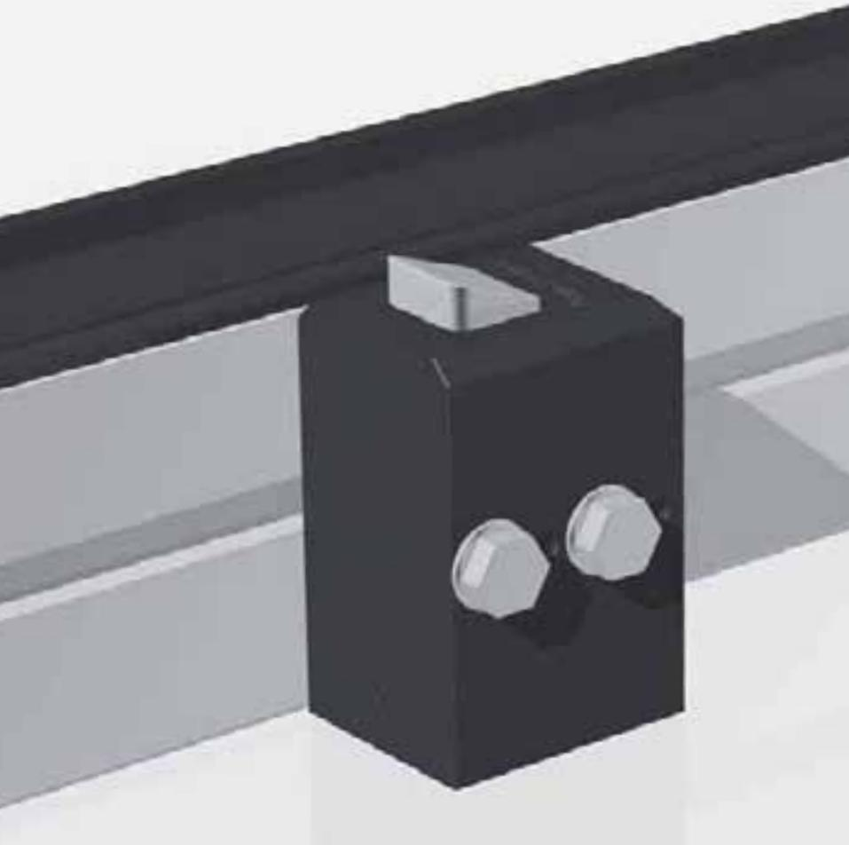
Die Rücklaufsperr verhindert beim das Zurückprallen der Palette beim Einsatz von ungedämpften Vereinzelnern. Die Rücklaufsperr ASRP kann auch pneumatisch abgesenkt werden um z.B. die Palette von Hand aus der Position zu schieben bzw. Reversierbetrieb.
