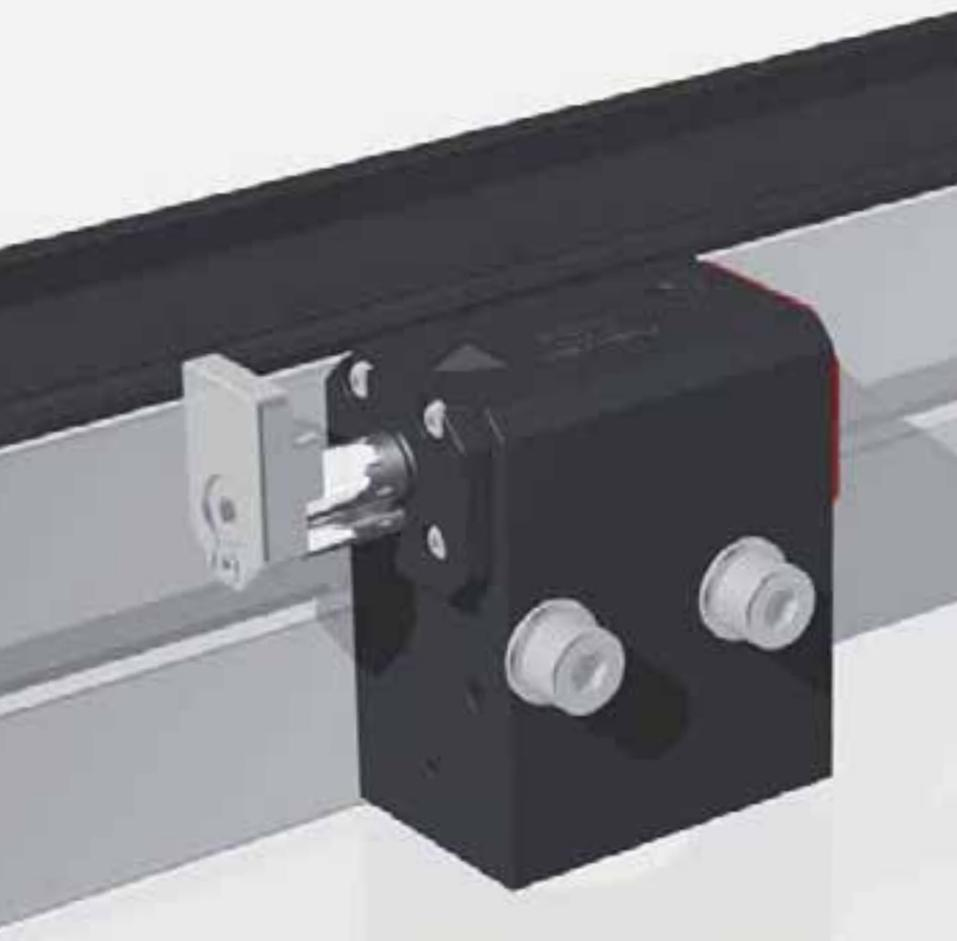
Stoppt, vereinzelt und dämpft einen oder mehrere auflaufende Werkstückträger an der definierten Werkstückträger-Anschlagplatte in Transfersystemen oder direkt am Werkstück. Kann auch zum Positionieren von z.B. Pneumatikzylindern verwendet werden.
