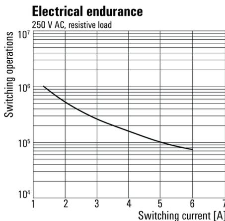
Elektrische Lebensdauer 230 V AC resistive load
