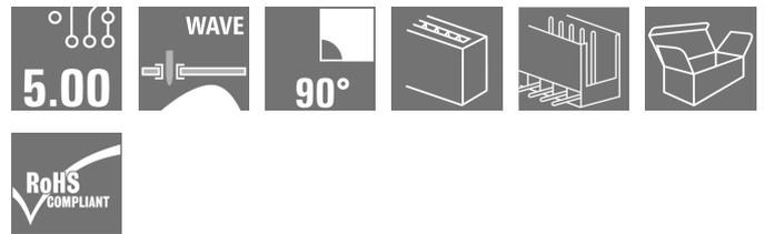
Stiftleisten mit 90° Abgangsrichtung. Die Lötstiftlänge ist für Wellenlötanwendungen optimiert. Die Stiftleisten bieten Platz für Beschriftungen und können kodiert werden.
