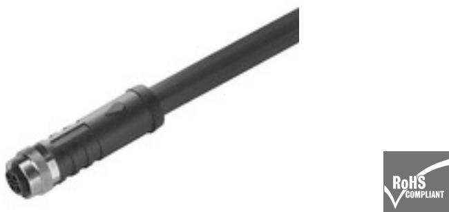
Ihre Geräte in der Peripherie sollen mit großer Leistung versorgt werden. Mit unsere neuen M12-Steckverbinder sind mehr als 250 V und 2 A problemlos möglich. Die kompakten S- und T-codierten M12-Steckverbinder sind auf die Übertragung von bis zu 630 V AC bzw. 60 V DC und 12 A ausgelegt.
