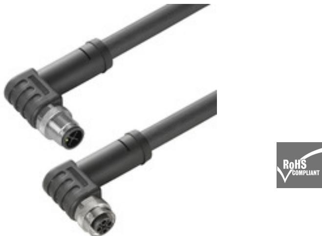
Ihre Geräte in der Peripherie sollen mit großer Leistung versorgt werden. Mit unsere neuen M12-Steckverbinder sind mehr als 250 V und 2 A problemlos möglich. Die kompakten S- und T-codierten M12-Steckverbinder sind auf die Übertragung von bis zu 630 V AC bzw. 60 V DC und 12 A ausgelegt.
