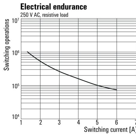
Elektrische Lebensdauer 230 V AC resistive load
