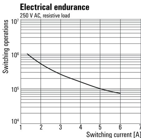
Elektrische Lebensdauer 230 V AC resistive load
