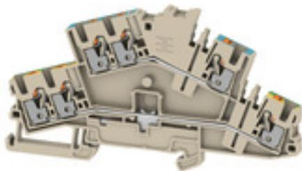
Das Durchführen von Energie, Signalen und Daten ist die klassische Anforderung in der Elektrotechnik und im Schaltschrankbau. Die maßgeblichen Merkmale sind dabei der Isolierstoff, die Anschlussstechnik und der Aufbau der Reihenklemmen. Mithilfe von Durchgangsreihenklemmen können ein oder mehrere Leiter zusammengeführt und/oder angeschlossen werden. Sie können eine oder mehrere Anschlussebenen haben, die auf dem gleichen Potenzial liegen oder voneinander getrennt sind.
