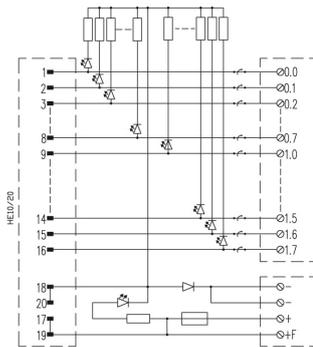
Das Schaltbild entspricht der Ausführung mit LEDs.
