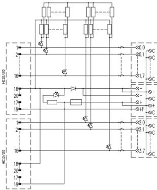
Das Schaltbild entspricht der Ausführung mit LEDs.
