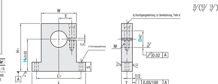
■ Zapfenbohrung für Gewindebohrung M ist möglicherweise durchgängig.
