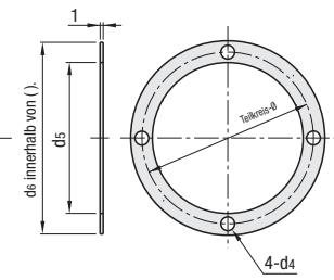
Die inbegriffene Dichtung ist bei Auslieferung nicht installiert. Vor der Benutzung installieren.
