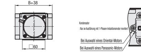
Die Maße in der Abbildung gelten für die Riemspezifikation H (0.9mm THK). Darauf achten, dass die Riemendicke je nach Riemspezifikation variiert. Zu Riemspezifikationen, siehe S.1279~.
