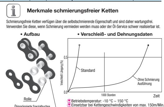
Kann die Verschleißdehnung aus langem Dauerbetrieb deutlicher als die Standardausführung unterdrücken.
