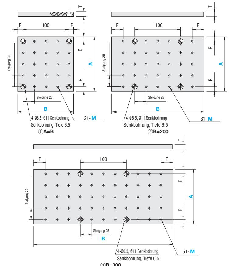
\* Befestigungsbohrungen für M6-Schrauben mit einer 100mm Steigung sind mittig auf den Platten angebracht.
