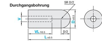
Bei der Ausführung mit Durchgangsbohrung wird, wenn kein Maß VL angegeben ist, eine Durchgangsbohrung gefertigt. Die Angabe des Maßes VL ist erforderlich. Die Durchgangsbohrung kann erstellt werden, aber die Bohrung kann nicht am SR angeschnitten werden.
