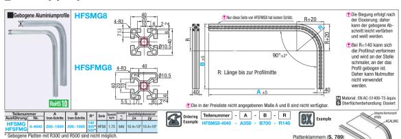
Merkmale: Gebogene Aluminiumprofile mit einem Radius von 140 mm
