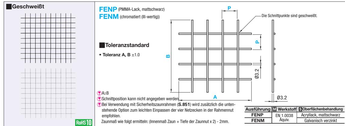
⚠ P15 und P25 können nicht mit Sicherheitszaunrahmen verwendet werden. Es wird empfohlen, eine Schlitzbreite von mindestens 6.5 mm für den Rahmen zu berücksichtigen.
