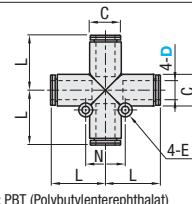
M Werkstoff: PBT (Polybutylenterephthalat)
