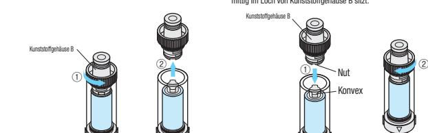
\*2 Achten Sie darauf, dass die Vakuum-Erzeugereinheit in die gleiche Richtung installiert, in die Markierung △ weist.
