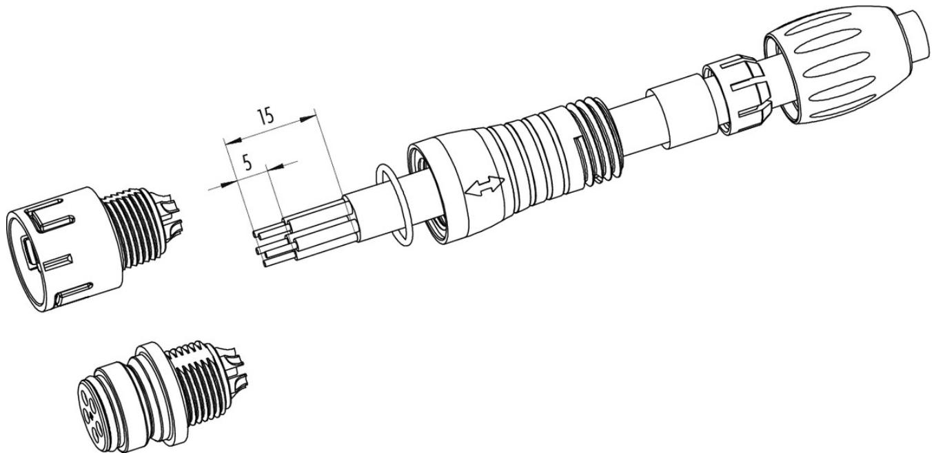
Bezeichnung **Polzahl: 8, Kabelstecker, Kabeldurchlass 4 - 6 mm, rot**
