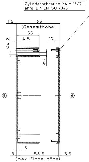
ABS-Gehäuse können durch eine andere Schwindung ca. 0,1-0,25% größer sein als gezeichnete PC-Gehäuse
