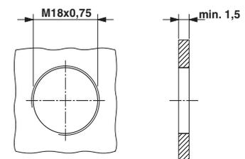
Einbaumaße: ST-17.1N8A6100S, Durchgangsbohrung mit
