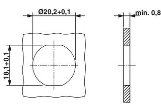
Einbaumaße: ST-.E.1N8AH100S, Bohrung mit Verdrehenschutz
