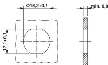
Einbaumaße: ST-17.1N8A6100S, Bohrung mit Verdrehenschutz
