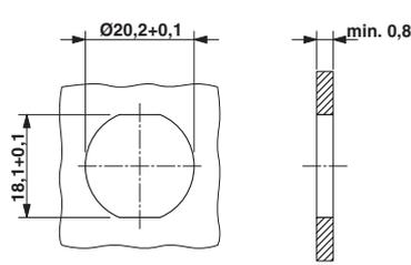
Einbaumaße: ST-17.1N8AH100S, Bohrung mit Verdrehenschutz
