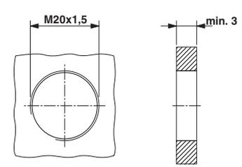
Einbaumaße: ST-17.1N8AH100S, Durchgangsbohrung mit
