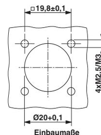
**Gerätesteckverbinder mit Kontaktträger zum Einrasten, Vorderwandmontage, geschirmt**
