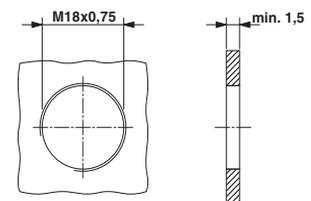
Einbaumaße: ST-.E.1N8AH100S, Durchgangsbohrung mit
