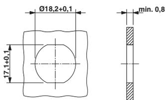
Einbaumaße: ST-.E.1N8A6100S, Bohrung mit Verdrehenschutz
