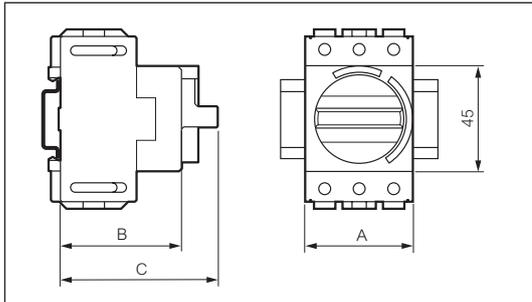
Sicherungstrennschalter, zur Gewährleistung von Unterbrechung und Phasentrennung. IP 2X
