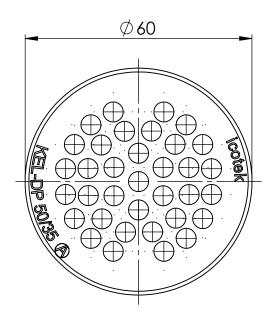
Kabeldurchführungsplatte für Blechstärke 1,5- 2,5 mm 35x Kabeldurchmesser bis max 5,2 mm
