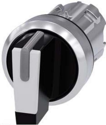
KNEBELSCHALTER, BELEUCHTBAR, 22MM, RUND, METALL, HOCHGLANZ, SCHWARZ, WEISS, KNEBEL, KURZ, 3 SCHALTSTELLUNGEN I-O-II, VERRASTEND, SCHALTWINKEL 2X45 GRAD, 10:30H/12H/13:30H
