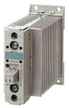
HALBLEITERSCHUETZ 1PHASIG 3RF2 AC51 30A 40 GRAD C 48-600V / 110-230VAC SCHRAUBANSCHLUSS SPERRSPANNUNG 1200V
