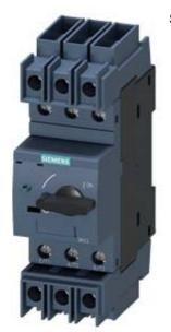
Leistungsschalter Baugröße S00 für den Anlagenschutz mit Approbation circuit-breaker UL 489, CSA C22.2 NO.5-02 A-Auslöser 12,5 A N-Auslöser 163 A Schraubanschluss Standardschaltvermögen
