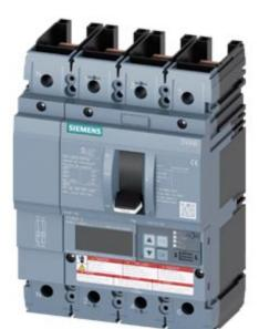
Leistungsschalter 3VA6 UL Frame 150 Schaltvermögenklasse C 100kA @ 480V 4-polig, Anlagenschutz ETU820, LI, In=100A Überlastschutz Ir=40A...100A Kurzschlussschutz Ii=1,5...12 x In ohne Anschluss
