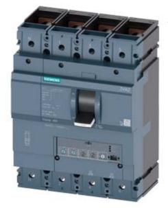
Leistungsschalter 3VA2 IEC Frame 400 Schaltvermögenklasse H Icu=85kA @ 415V 4-polig, Anlagenschutz ETU350, LSI, In=250A Überlastschutz Ir=100A...250A Kurzschlussschutz Isd=1,5...10 x Ir, Ii=12 x In N-Leiterschutz einstellbar (OFF, 50%, 100%) Schraubenflachanschluss
