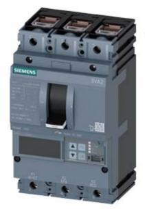
Leistungsschalter 3VA2 IEC Frame 160 Schaltvermögenklasse M Icu=55kA @ 415V 3-polig, Anlagenschutz ETU860, LSIG, In=25A Überlastschutz Ir=10A...25A Kurzschlussschutz Isd=0,6..10x In, Ii=1,5..12x In N-Leiterschutz optional mit externem Stromwandler, bis 160% Erdschlussschutz, abschaltbar Ig=0,2...1 x In, tg=0,05-0,8s Klemmenanschluss
