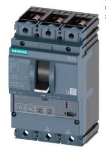
Leistungsschalter 3VA2 IEC Frame 100 Schaltvermögenklasse C Icu=110kA @ 415V 3-polig, Anlagenschutz ETU330, LIG, In=100A Überlastschutz Ir=40A...100A Kurzschlussschutz Ii=1,5...12 x In Erdschlussschutz Ig=0,2...1 x In, tg=0,1/0,3s Schraubenflachanschluss
