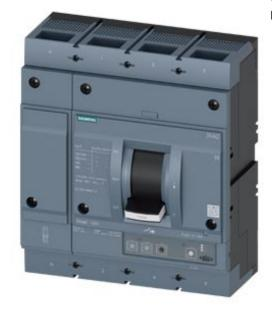
Leistungsschalter 3VA2 IEC Frame 1000 Schaltvermögenklasse M Icu=55kA @ 415V 4-polig, Anlagenschutz ETU320, LI, In=800A Überlastschutz Ir=320A...800A Kurzschlussschutz Ii=1,5...10 x In N-Leiterschutz einstellbar (OFF, 50%, 100%) Schraubenflachanschluss
