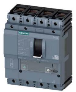
Leistungsschalter 3VA2 IEC Frame 160 Schaltvermögenklasse M Icu=55kA @ 415V 4-polig, Anlagenschutz ETU340, ELISA LI, In=100A Überlastschutz Ir=40A...100A Kurzschlussschutz Ii=15 x In N-Leiterschutz einstellbar (OFF, 50%, 100%) Klemmenanschluss
