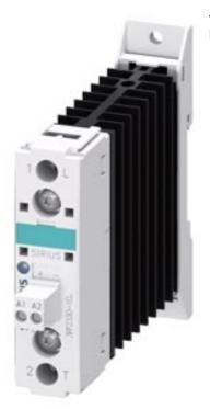
Halbleiterschütz 1-phasig 3RF2 AC 51 / 30 A / 40 °C 48-460 V / DC 24 V low power kurzschlussfest bis 25 A mit B-Automat
