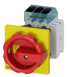
Lasttrennschalter 3LD3, Iu 40 A Hauptschalter 3-polig Bemessungsbetriebsleistung bei AC-23 A bei 400V 15,0 kW Frontbefestigung Basisschalter mit Zentrallochbefestigung 22,5mm Knebelantrieb rot/gelb 66x66 mm mit Hilfsschalter 10E+1S
