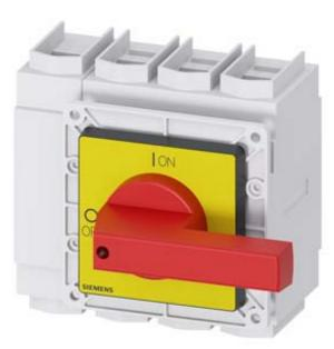
SENTRON, Lasttrennschalter 3LD, Not-Aus-Schalter, 4- polig, Iu: 160 A, Betriebsleistung / bei AC-23 A bei 400V: 75 kW, Frontbefestigt, Knebelantrieb, rot/gelb, 4-Loch Befestigung der Handhabe
