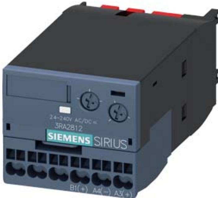
Elektronisches Zeitrelais rückfallverzögert mit Steuersignal und Halbleiterausgang AC/DC 24...240 V Zeitbereich 0,05...100 s frontseitig aufschraubbar für Schütze 3RT2 S00/S0 Federzuganschluss Varistor zur Bedämpfung der Schützspulen integriert
