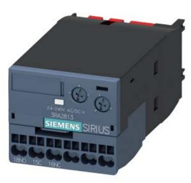
Elektronisch zeitverzögerter Hilfsschalter ansprechverzögert Relais 1 Wechsler AC/DC 24...240 V Zeitbereich 0,05...100 s frontseitig aufschnappbar für Schütze 3RT2 S00-S3 Federzuganschluss Varistor zur Bedämpfung der Schützspulen integriert
