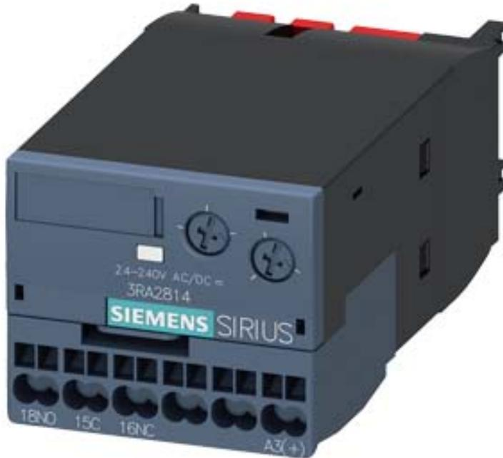
Elektronisch zeitverzögerter Hilfsschalter rückfallverzögert mit Steuersignal Relais 1 Wechsler AC/DC 24...240 V Zeitbereich 0,05...100 s frontseitig aufschraubbar für Schütze 3RT2 S00-S3 Federzuganschluss Varistor zur Bedämpfung der Schützspulen integriert
