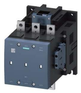
Vakuumschütz, AC-3 400 A, 200 kW / 400 V AC (50-60 Hz) / DC-Betätigung UC 200-277V Hilfskontakte 2 NO + 2 NC 3-polig, Baugröße S12 Schienenanschlüsse Antrieb: elektronisch mit SPS-Schnittstelle DV 24 V
