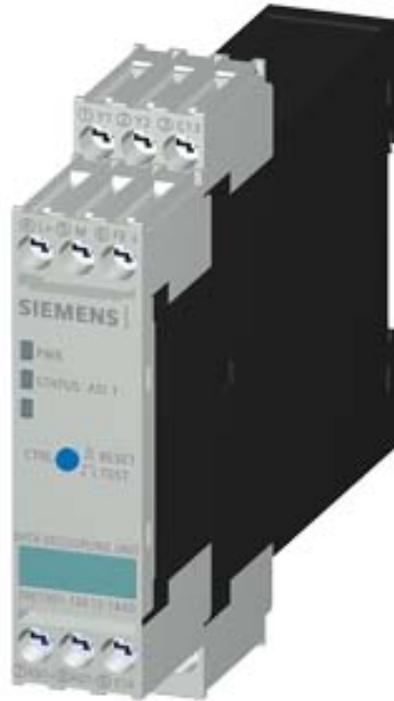
AS-i Datenentkoppler 1 x 4 A Schraubklemmen, AS-i einfach Datenentkopplungsmodul IP20, SlimLine S22,5 Schraubklemmen Baubreite Modul 22,5 mm IN: DC 24 V / 30 V OUT: 1 x AS-I, 4 A integrierter Überlastschutz integrierte Erdschlusserkennung Meldekontakt Fernreset
