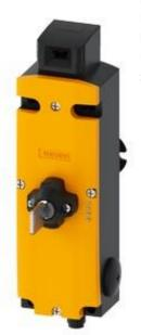
Sicherheits-Positionsschalter mit Zuhaltung Zuhaltekraft 2600 N 5 Anfahrrichtungen Metallgehäuse, M12-Stecker ASIsafe integriert Kanal 1=Betätiger 1Ö Kanal 2=Magnet 1Ö federkraftverriegelt Fluchtentriegelung hinten und Hilfsentriegelung vorne mit Schloss Magnetspannung DC 24 V/AC Überwachung Betätiger 2Ö/1S Überwachung Magnet 2Ö/1S der dazu passende getrennte Betätiger 3SE5000-0AV0 muss separat bestellt werden
