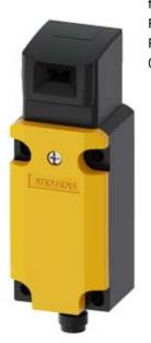
Sicherheits-Positionsschalter mit getrenntem Betätiger Metallgehäuse, 40 mm nach DIN EN 50041 mit M12-Stecker, 5-polig, fest mit 2 LED, gelb/grün DC 24 V 5 Anfahrrichtungen Pin-Belegung: Pin1=21, Pin2=22 Pin3=14 und LED grün, Pin4=13 und LED gelb, Pin 5=Masse LED der dazu passende getrennte Betätiger 3SE5000-0AV0. muss separat bestellt werden
