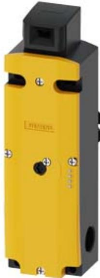
Sicherheits-Positionsschalter mit Zuhaltung Zuhaltkraft 1300 N 5 Anfahrrichtungen Federkraftverriegelt Notentsperrung hinten und Hilfsentriegelung vorne Magnetspannung AC 115 V Überwachung Betätiger 2Ö/1S Überwachung Magnet 2Ö/1S LED-Anzeige gelb/grün Lieferung ohne Betätiger. Betätiger 3SE5000-0AV0. bitte separat bestellen
