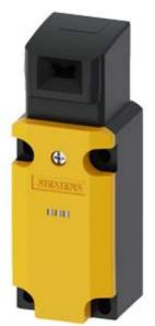
Sicherheits-Positionsschalter mit getrenntem Betätiger Kunststoffgehäuse 40 mm 1 x (M20 x 1,5) Schleichschaltglieder 1S+2Ö mit 2 LEDs gelb/grün DC 24 V 5 Anfahrrichtungen der dazu passende getrennte Betätiger 3SE5000-0AV0. muss separat bestellt werden
